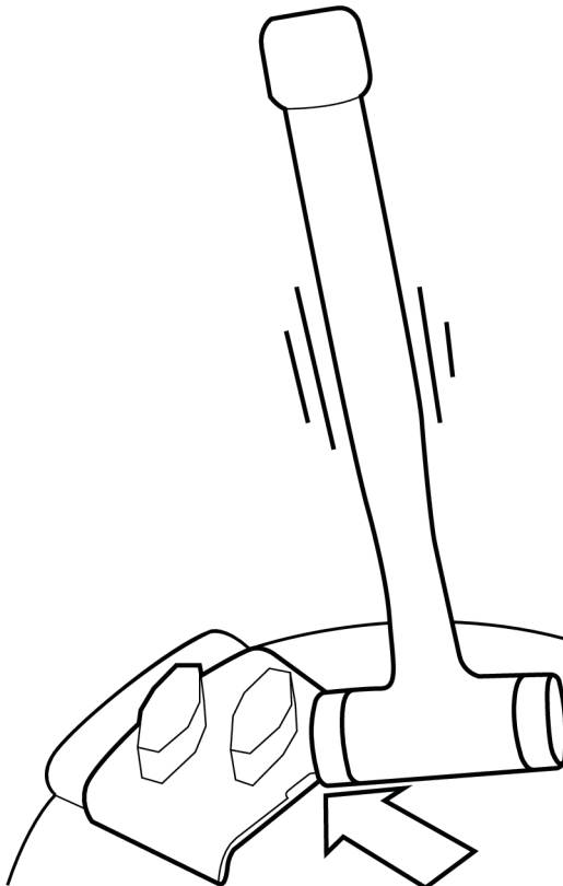
Abbildung 4-4. Verriegeln eines Schleifwerkzeugs
