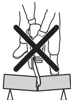
Se la catena è schiacciata o bloccata nel settore di contraccollo, la forza di reazione respingerà la troncatrice in senso rotatorio in alto e indietro verso l'utente causando lesioni gravi o mortali. Fare attenzione al possibile spostamento del pezzo in lavorazione. Controllare che il pezzo in lavorazione non si muova durante il taglio, per impedire che schiacci l'attrezzatura di taglio nel taglio.
