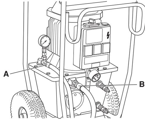
Hidraulinė žarna, grįžimo įleidimas (B)
