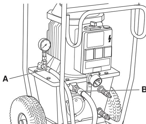
Hidrauliskā šļūtene, IENĀKOŠĀ atgrieze (B)
