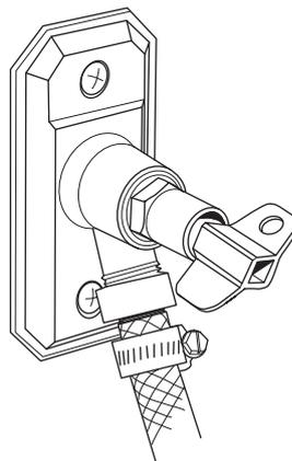
Если для эксплуатации инструмента подача воды не требуется, охлаждающая жидкость тем не менее должна проходить через радиатор, а затем стекать в ближайший слив в полу.
