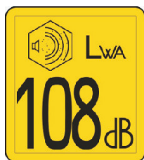
部件号 543 04 57-88 声级 - 108dBA 位置：RH 架上方
