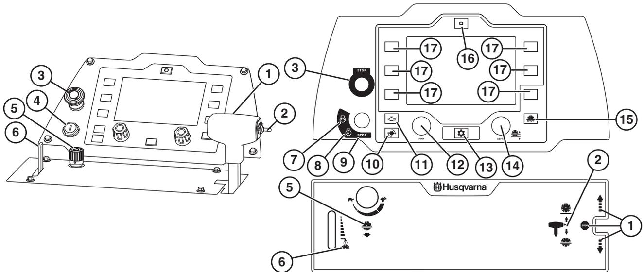
Le panneau de commande est l'élément qui relie l'opérateur à la machine. À partir de ce panneau, l'opérateur peut contrôler la vitesse de rotation du moteur en tours par minute, commander la profondeur de coupe de la lame et afficher l'état actuel du moteur et de la machine.
