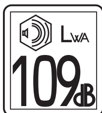
P/N 578 01 42-01 MELUTASO - 109 dBA Sijainti: ylempi, oikeanpuoleinen runko
