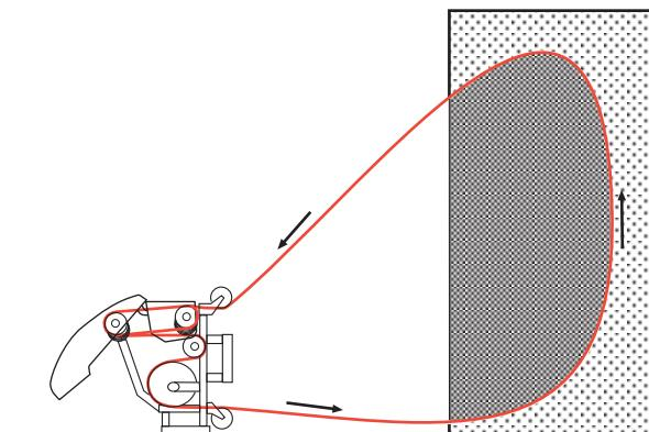
Cưa được lắp theo chiều ngang khi vết cắt sẽ được thực hiện ở chiều cao tầng nhà và khi vết cắt được thực hiện trong tầng nhà.
