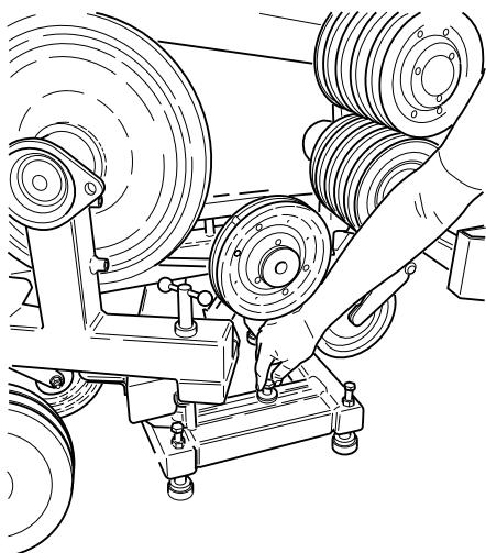
请记住，水平切割 (A) 时，机器的重心（灰色圆环）位于第一对和第二对调整脚之间（调整脚顺序已标注为 1-3）。当在机器下进行切割时，非常重要的一点是，必须使用第 2 对和第 3 对调整脚，用固定螺栓 (b) 固定好锯。（切割进行时可以收起第 1 对调整脚）当第 1 对调整脚所支撑的材料完成切割后，如果锯没有很好固定，将会倾翻。
