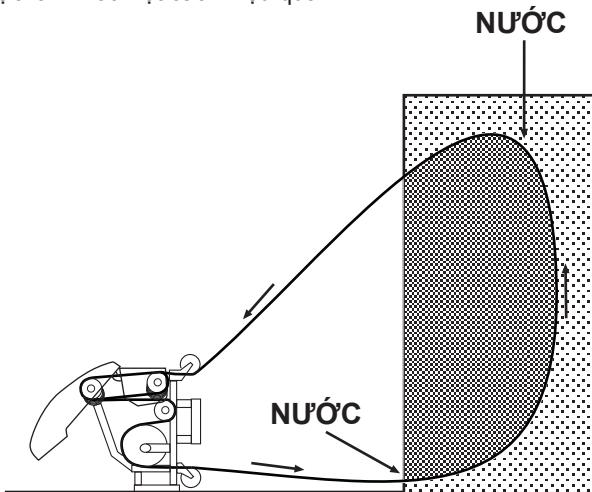
Ngoài nước làm mát từ cây giáo nước, dây còn được gội rửa bằng hai bánh quay trên máy. Điều này giúp giữ cho dây sạch nhất có thể, đồng nghĩa với cưa có thể hoạt động với ít tổn thất ma sát hơn và hiệu suất lớn hơn vì dây sạch hơn.
