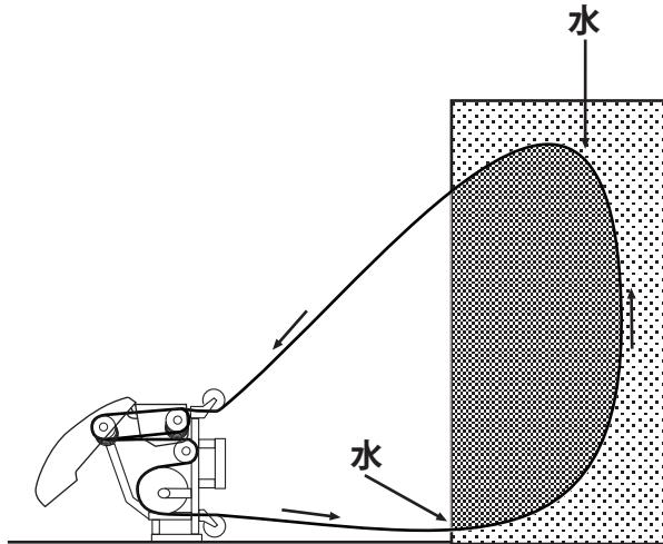
ウォーターノズルからの冷却水に加えて、ワイヤーはマシン上の 2 つのスイベルホイールによって洗浄されます。これは、できるだけワイヤーを清潔に保つためです。つまり、ワイヤーが清潔であれば、摩擦による喪失がより少なく、効率がより優れた状態でソーの作業が行えます。
