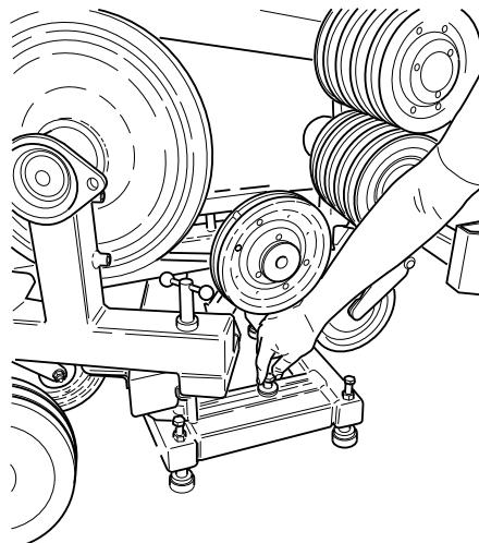
水平方向の切断 (A) では、マシンの重心 (灰色の円) が最初と 2 番目の調整脚の間に来るよう配置してください (調整脚のペアには 1 ~ 3 と記されています)。マシンの下を切断する場合、調整脚 2 と 3 を使用しなければならず、アンカーボルト (b) を用いてソーが固定されていることが重要です。(調整脚のペア 1 は、切断面上に置いてもかまいません)。ソーが十分に固定されていない場合、調整脚 1 を支えるものを切断するとひっくり返ります。
