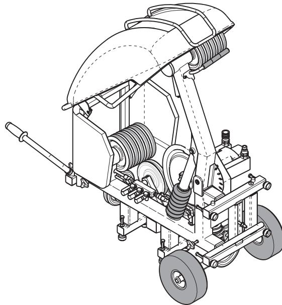
Husqvarna CS 2512 direka bentuk untuk digunakan bersama-sama dengan unit hidraulik PP 455 E atau Husqvarna RC 455. Husqvarna CS 2512 merupakan gergaji dawai yang berkuasa dan mudah digunakan dengan kapasiti untuk kerja yang sangat besar, namun pada masa yang sama cukup kompak dan mudah alih untuk kerja yang kecil. Ia boleh digunakan dalam pelbagai cara, kedua-dua di atas tanah dan dipasang pada dinding.
