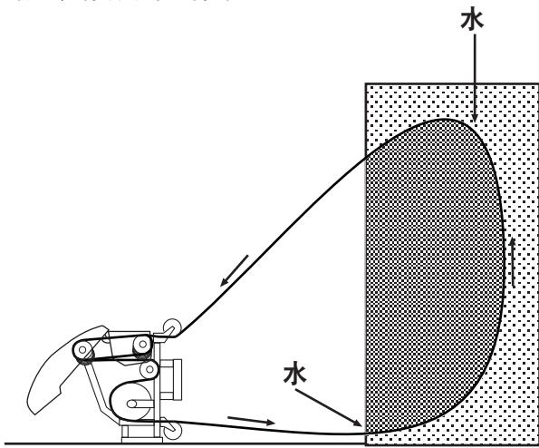
除了水枪里的冷却水之外，可以用机器上的两个旋转轮冲洗金属线。这可以让金属线尽量保持清洁，同时使锯在工作时减少磨损，而且因金属线更清洁而更加高效。
