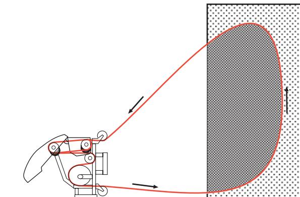
Gergaji dipasang mendatar apabila potongan akan dibuat pada ketinggian lantai dan apabila pemotongan itu dibuat di lantai.
