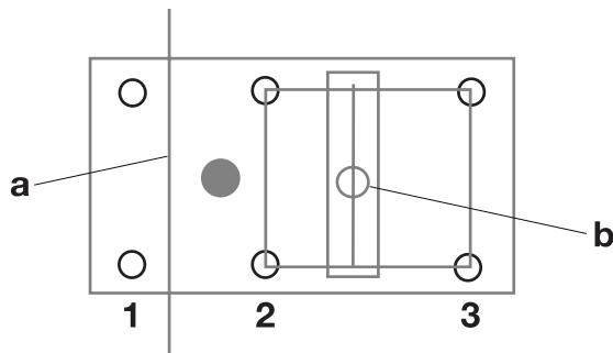
Jika perlu, pasang roda takal untuk membantu proses pemotongan. Menggunakan roda takal mengurangkan bilangan bucu tajam yang dawai mesti ditarik di sekelilingnya dan pada masa yang sama mengurangkan kehausan pada dawai kerana pemotongan kini lebih mudah. Menggunakan roda takal juga membolehkan dawai dipandu dalam arah yang berlainan tanpa perlu menggerakkan unit gergaji.
