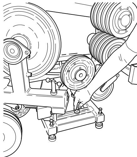
Hãy nhớ rằng trọng tâm của máy cưa (vòng tròn màu xám) được đặt giữa cặp chân điều chỉnh thứ nhất và thứ hai (cặp chân điều chỉnh được đánh dấu 1-3) với vết cắt ngang (A). Khi cắt dưới máy cưa, điều quan trọng là cưa phải được gắn chặt bằng bu-lông neo (b) và phải sử dụng cặp chân điều chỉnh 2 và 3. (Cặp chân điều chỉnh 1 có thể ở trên phần đã cắt rời.) Nếu cưa không được gắn chặt nó sẽ bị lật sau khi cắt qua cặp chân điều chỉnh nâng đỡ vật liệu.
