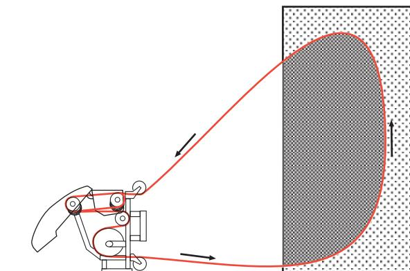
フロアの高さで切断を行うとき、およびフロアに切断を行う場合は、ソーを水平に組み立てます。
