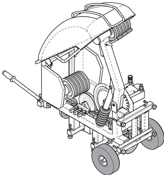
**Husqvarna CS 2512**는 유압 장치 **PP 455 E**나 **Husqvarna RC 455**와 함께 사용하도록 설계되었습니다. **Husqvarna CS 2512**는 강력하고 사용하기 편한 와이어 톱으로서 매우 큰 작업에 적합한 용량을 갖고 있으면서도 소규모 작업에 적합하게 작고 이동성이 우수합니다. 지상 또는 벽에 설치하는 것을 포함하여 다양한 방식으로 사용할 수 있습니다.
