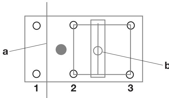
Nếu cần, hãy lắp bánh pu-li để hỗ trợ quá trình cắt. Sử dụng các bánh pu-li cho phép giảm số lượng góc sắc nhọn mà dây phải kéo xung quanh, giúp dây ít mòn rách hơn đồng thời cắt dễ dàng hơn. Sử dụng các bánh pu-li cũng cho phép dẫn dây theo nhiều hướng khác nhau mà không cần phải di chuyển máy cưa.
