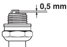
**ЗАМЕЧАНИЕ!** Всегда используйте только указанный тип свечи! Применение несоответствующей модели может привести к серьезным повреждениям поршня/цилиндра.
