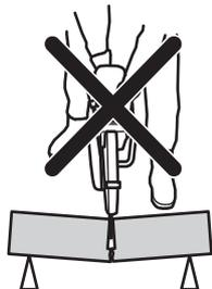
Si la lame se pince ou se coince dans la zone de rebond, la force de réaction va pousser la découpeuse vers le haut, puis la faire retomber en direction de l'utilisateur dans un mouvement de rotation qui peut causer des blessures sérieuses, voire mortelles.
