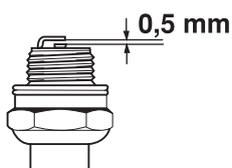
**ATTENTION !** Toujours utiliser le type de bougie recommandé! Une bougie incorrecte peut endommager le piston/le cylindre.
