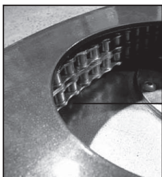
Diesen Bereich auf Verunreinigungen kontrollieren
