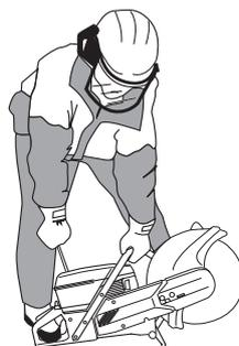
Agarre depois a pega do arranque com a mão direita e puxe a corda lentamente até sentir resistência (o mecanismo de arranque começa a actuar) e em seguida puxe com movimentos rápidos e fortes.
