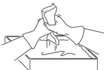
Coloque o filtro num saco de plástico e deite óleo para filtros. Amasse o saco plástico para distribuir o óleo. Remova o filtro, comprimindo o saco, e deite fora o excesso de óleo antes de montar o filtro na máquina. Nunca utilize óleo de motor comum. Este desce rapidamente pelo filtro e acumula-se no fundo.
